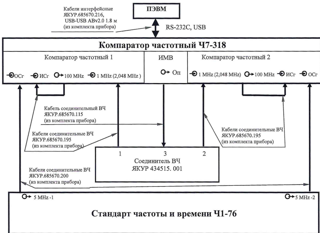
Рисунок Б.4 – Схема соединений при определении вносимой нестабильности частоты для импульсных сигналов частоты 1 и 2,048 МГц
