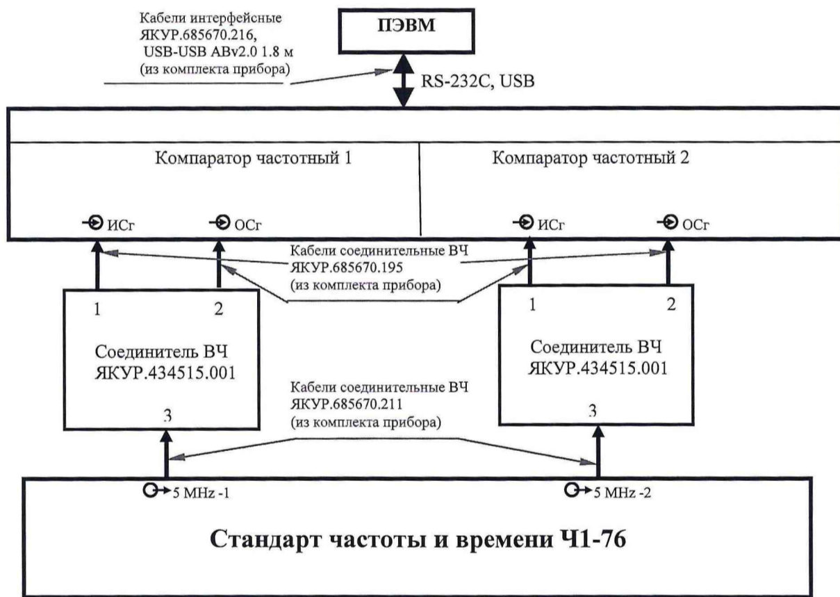
Рисунок Б.3 – Схема подключения сигналов при определении нестабильности частоты, вносимой прибором для синусоидальных входных сигналов
