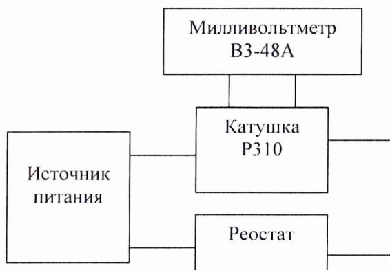
Рисунок 4 - Структурная схема соединения приборов при определении пульсаций выходного тока.
