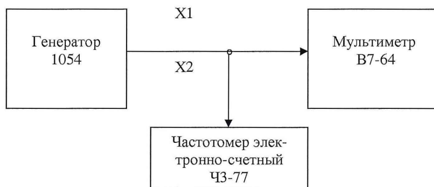
Рисунок 5.1 - Структурная схема соединения приборов
