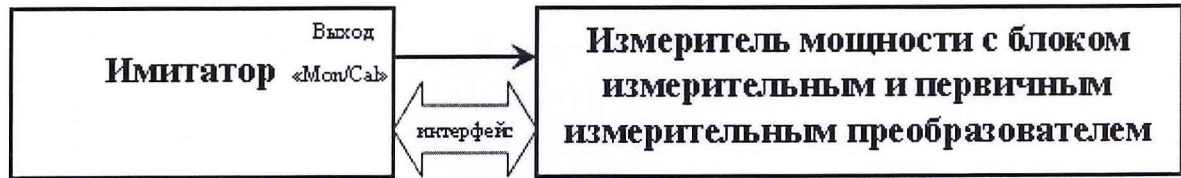
Рисунок 5 – Схема рабочего места для определения номинального уровня мощности выходных сигналов
