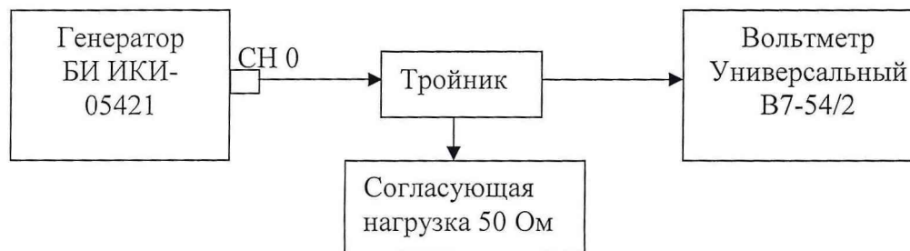
Рисунок 6.3 - Схема измерений диапазонов и погрешности установки уровня выходного напряжения синусоидального сигнала
