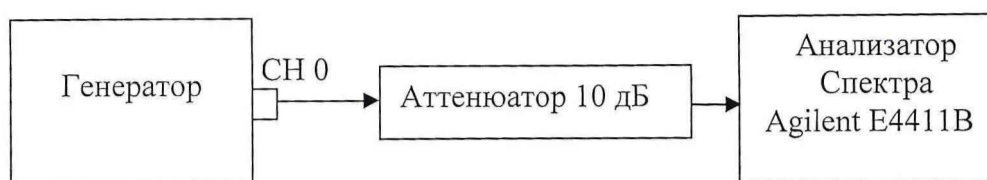
Рисунок 6.6 - Структурная схема соединения приборов при определении относительного уровня гармонических составляющих по основному тракту с высоким усилением
