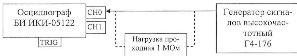
Рисунок 6.5 - Структурная схема соединения приборов при определении минимального уровня синхронизации
