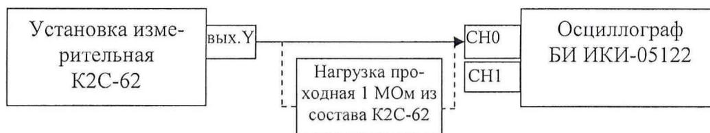
Рисунок 6.1 – Структурная схема соединения приборов при опробовании
