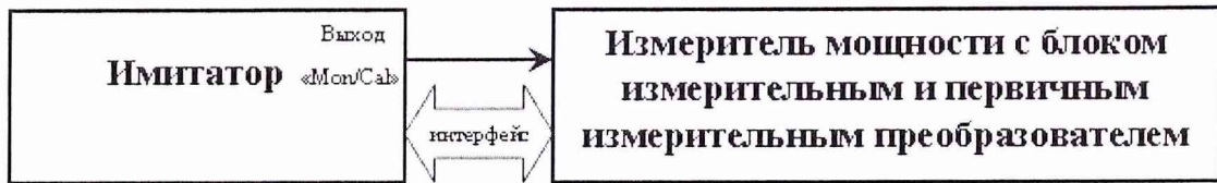
Рисунок 3 – Схема измерений для определения номинального уровня мощности выходных сигналов
