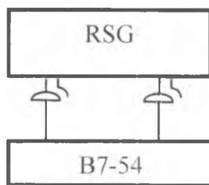
Рисунок 1 – Структурная схема проверки ослабления на постоянном токе
