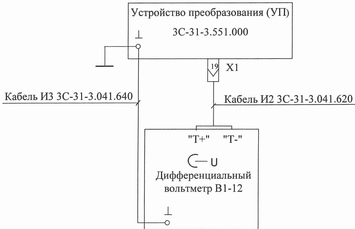
Рисунок 3 – Схема подключения для УП1.4 – УП16.4 при проверке ИК напряжения постоянного тока, соответствующего значениям относительной влажности воздуха.
