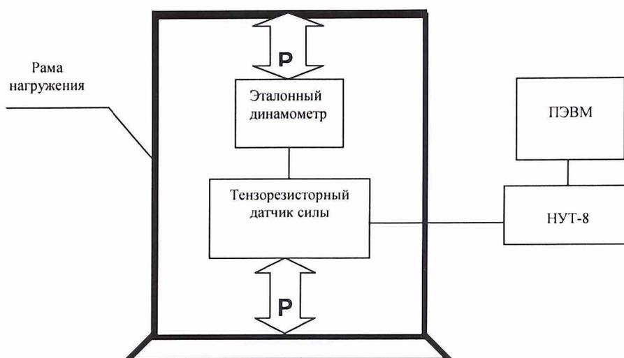
Рисунок 1 - Функциональная схема поверки ИК силы
