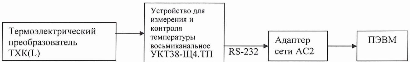
Рисунок 2 – Функциональная схема ИК температуры
