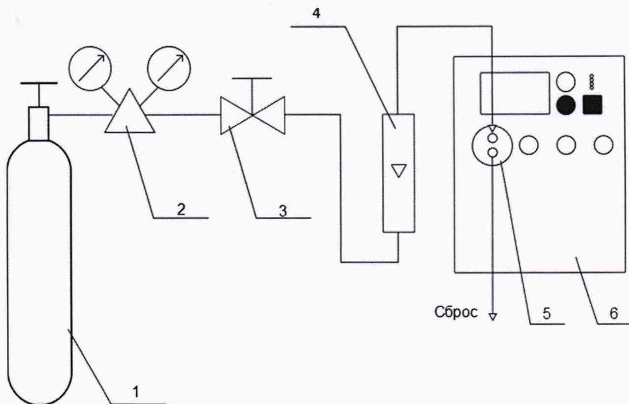
1 – баллон с ГС; 2 – редуктор баллонный; 3 – вентиль точной регулировки трассовый; 4 – ротаметр (индикатор расхода); 5 – система (условно изображена SENTRO 8); 6 – насадка для подачи ГС
