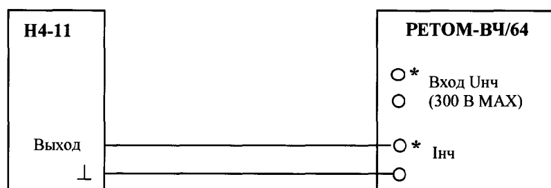
Рисунок 3.9 – Схема проверки основной абсолютной погрешности измерений среднего значения силы постоянного тока и среднеквадратичного значения силы переменного тока в диапазоне от 10 до 100 % от предела измерения (Вход I_{нч} )
