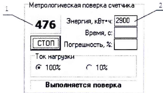
Рисунок 5 – ПО. Поле «Метрологическая поверка счетчика». Выполнение поверки 1 – ориентировочное время ожидания конца поверки; 2 – показания счетчика
