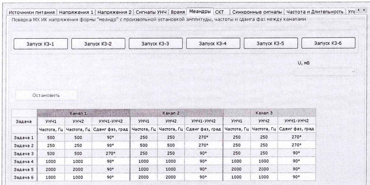
Рисунок 10 – Вкладка «Меандры» для проверки МХ ИК воспроизведения напряжения формы «униполярный меандр» с произвольной установкой амплитуды, частоты и сдвига фаз между каналами
