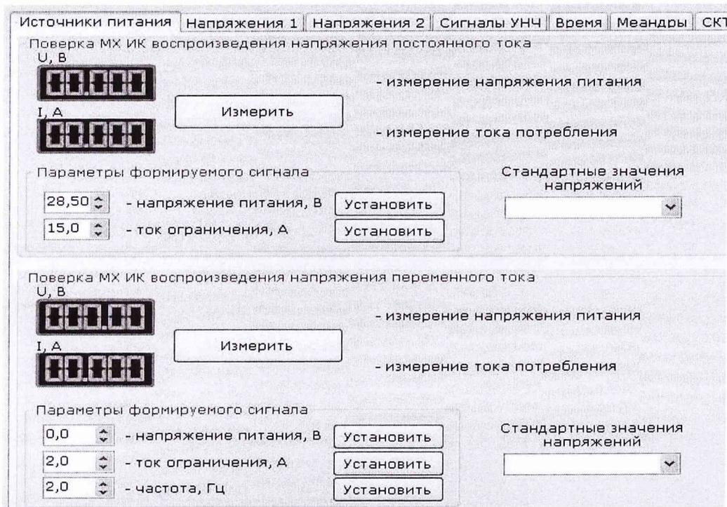
Рисунок 6 – Вкладка «Источники питания» для поверки МХ ИК воспроизведения напряжения постоянного тока
