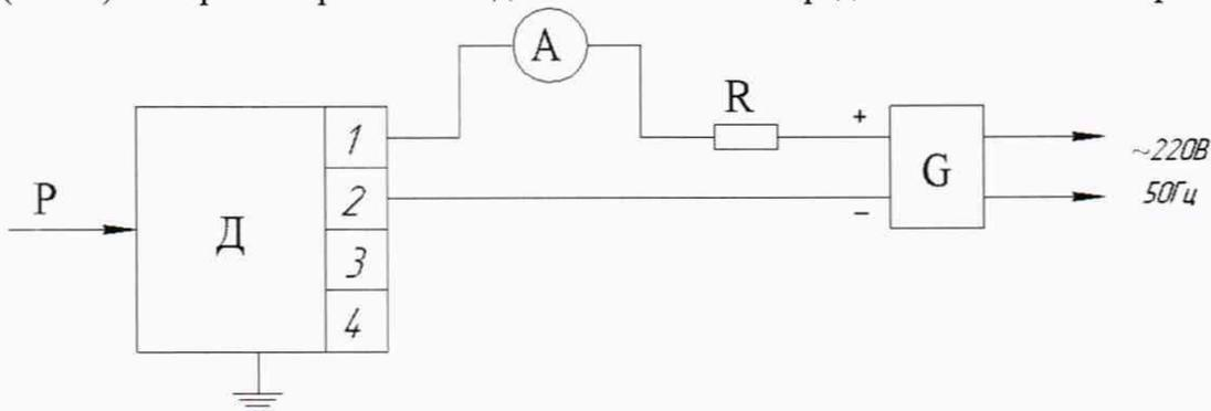
Р – входная измеряемая величина (примеры подключения к датчику эталонных СИ входной величины и эталонных задатчиков давления приведены на схемах 8 и 9 соответственно);
