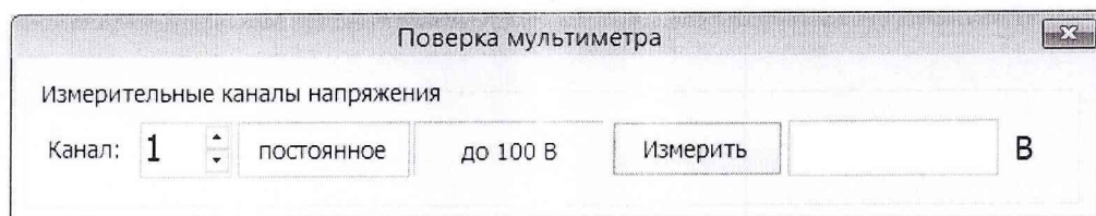
Рисунок 8.32 – Окно «Поверка мультиметра». Измерение напряжения постоянного тока до 100 В.
