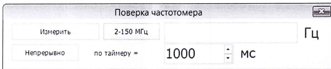
Рисунок 8.40 – Окно «Поверка частотомера». Измерение частоты до 150 МГц.
