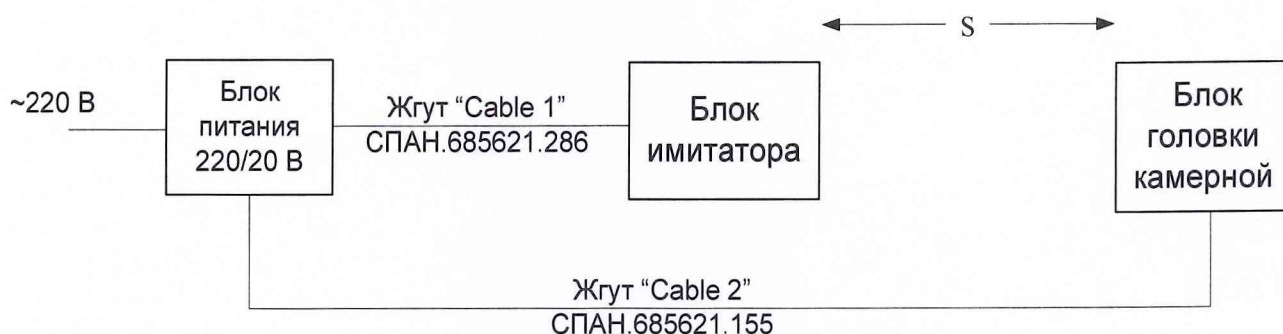
Рисунок 5 – Схема подключения блоков изделия
