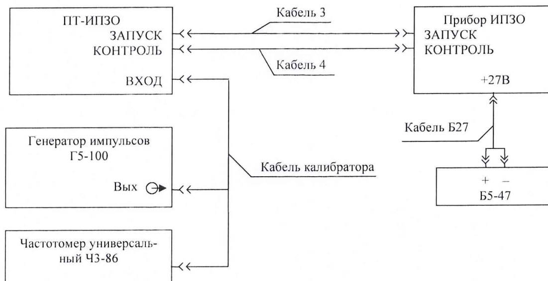
Рисунок 10 - Определение погрешности измерений временных характеристик видеосигналов
