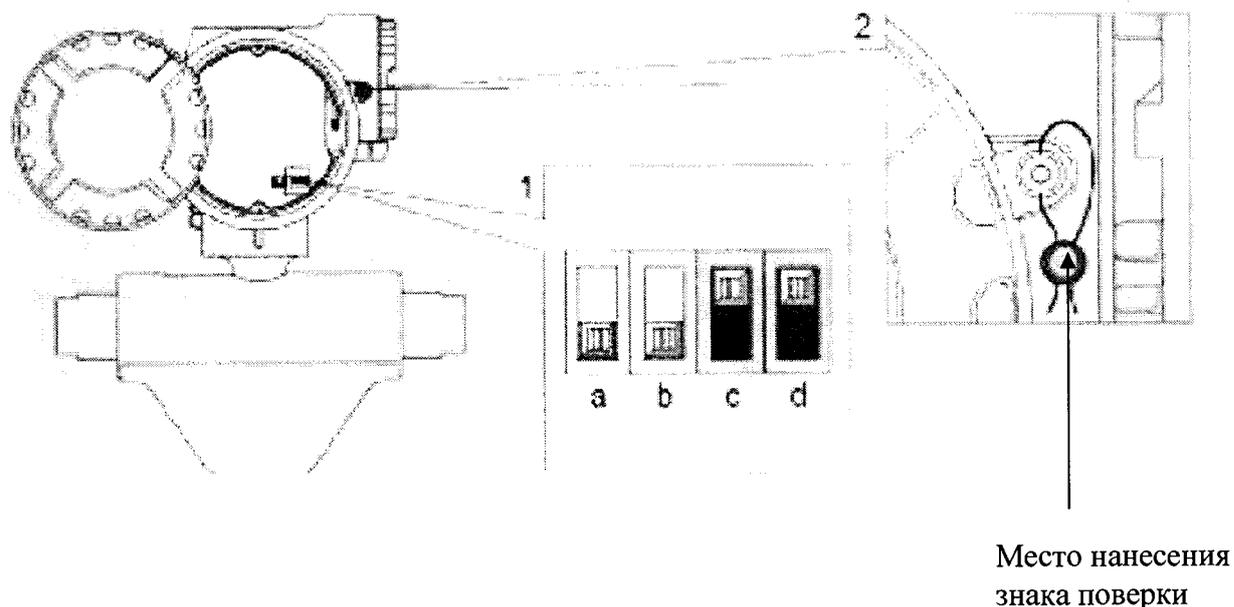
Рисунок 1 – Схема пломбировки расходомера массового CNGmass 8FF15
