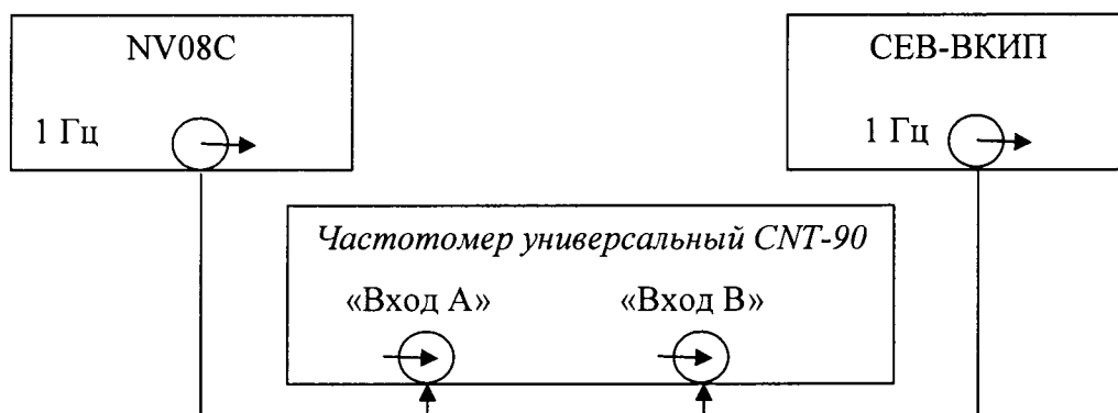
Рисунок 1 – Схема определения относительной погрешности по частоте
