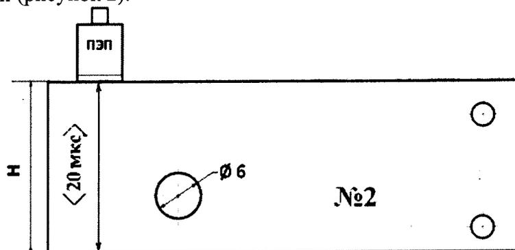
Рисунок 2 – Контрольный образец №2 из комплекта КОУ-2
