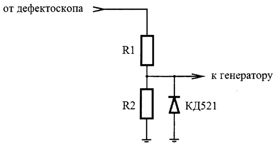
Для защиты канала синхронизации генератора от высокого напряжения импульса возбуждения с выхода канала дефектоскопа, необходимо использовать согласующее устройство.
