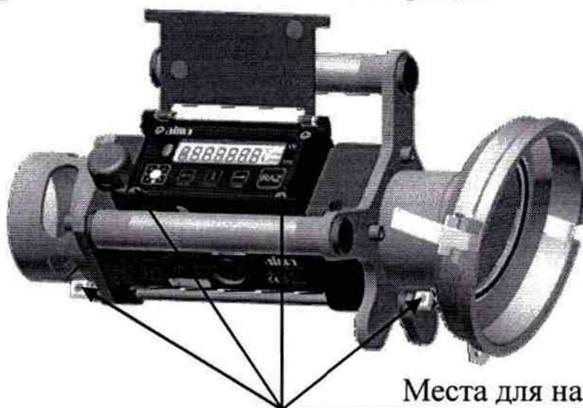
Места для нанесения знака поверки с помощью ударных поверительных клейм
