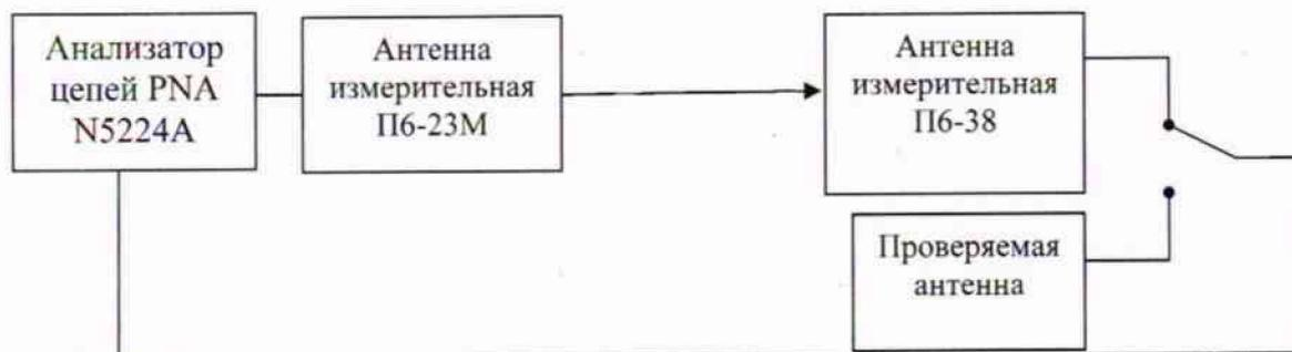
Рисунок 1 - Структурная схема соединения приборов
