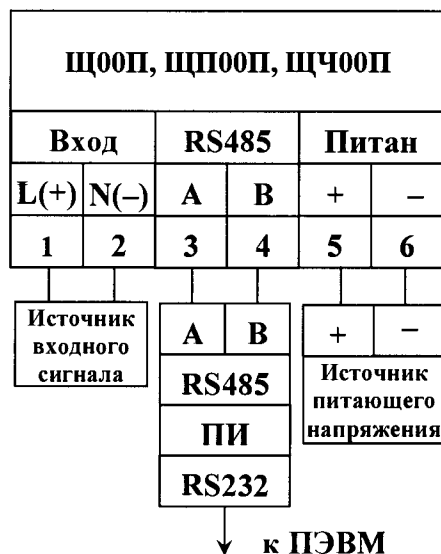
Рисунок А.1 – Схема подключения приборов Щ00П, ЩП00П, ЩЧ00П
