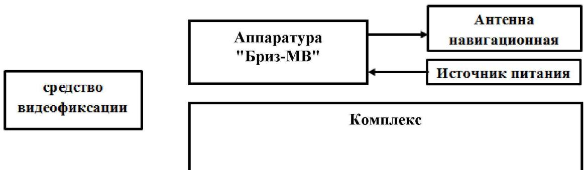
Рисунок 1 - Схема проведения измерений при определении абсолютной погрешности синхронизации формируемой ШВ со ШВ UTC (SU)
