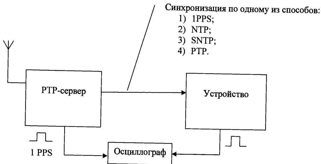
Рисунок 6 – Проверка погрешности измерения текущего времени
