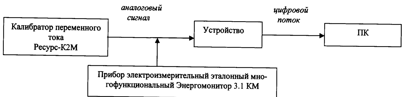
Рисунок 4 – Проверка метрологических характеристик устройств depRTU - SV- xxx (предназначенных для измерения силы и напряжения переменного тока и выдачи цифровых потоков в режиме реального времени)
