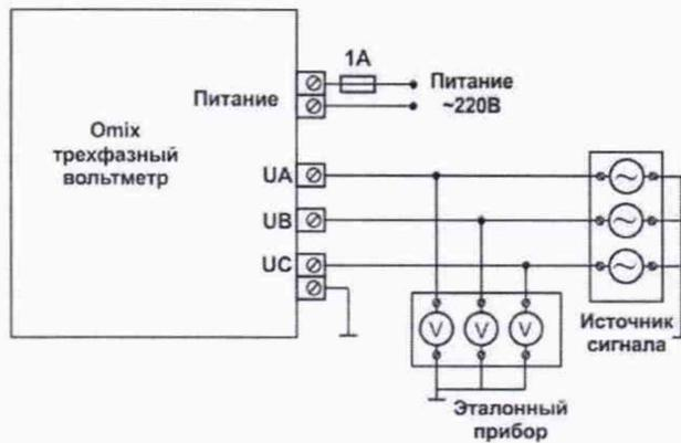
Рисунок 2- Схема подключения входных каналов для измерения переменного напряжения
