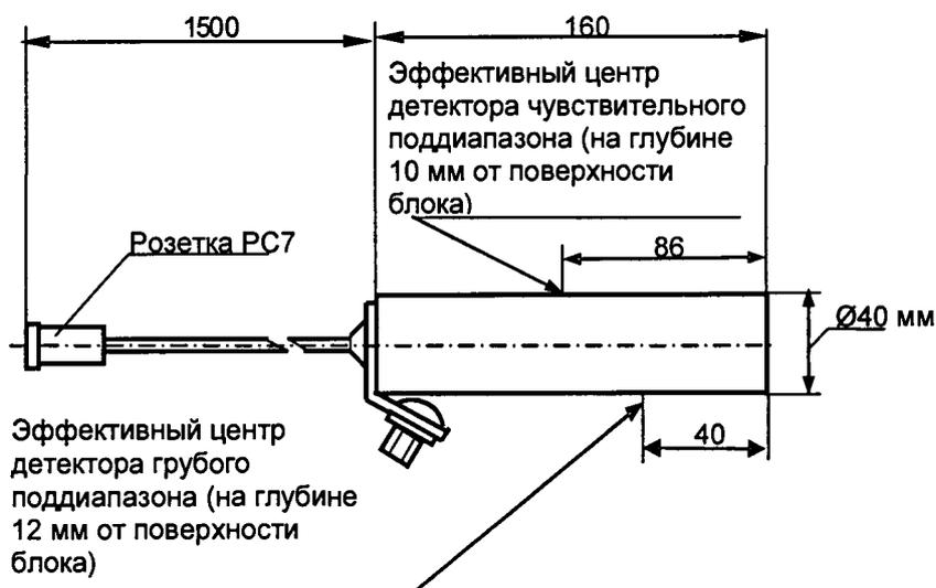
Рисунок В.1 - Расположение эффективного центра детектора блока детектирования БДМГ-100
