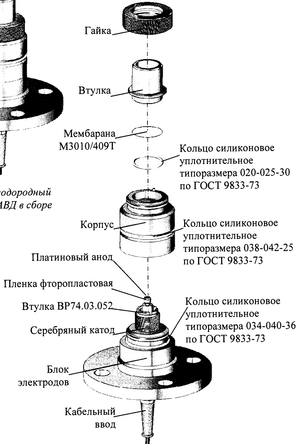
б – Конструкция датчика водородного ДВ-509АВД
