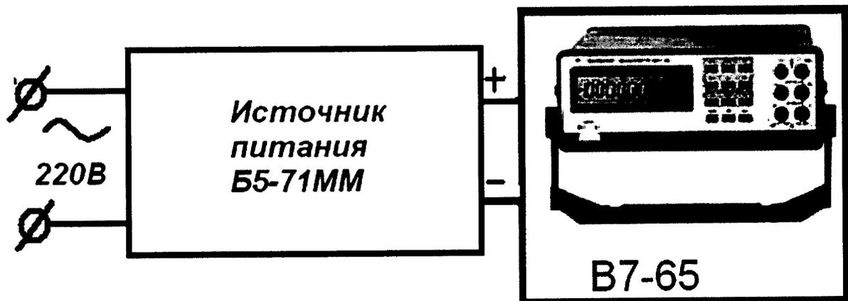
Рисунок 8.1 – Схема определения абсолютной погрешности установки выходного напряжения, абсолютной погрешности измерения выходного напряжения ИП в режиме стабилизации напряжения
