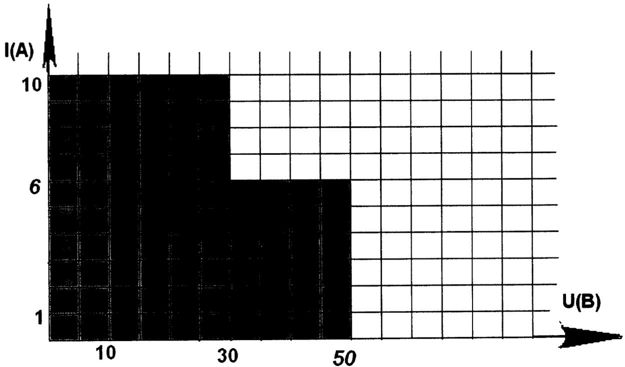
Рисунок 1.1- режимы установки выходных напряжения и тока.
