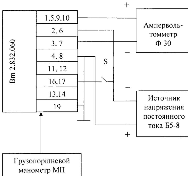
Соединение приборов измерительных между собой проводить, используя провод МГТФ 0,12 ТУ 16.505.185-71 длиной не более 2 м.
