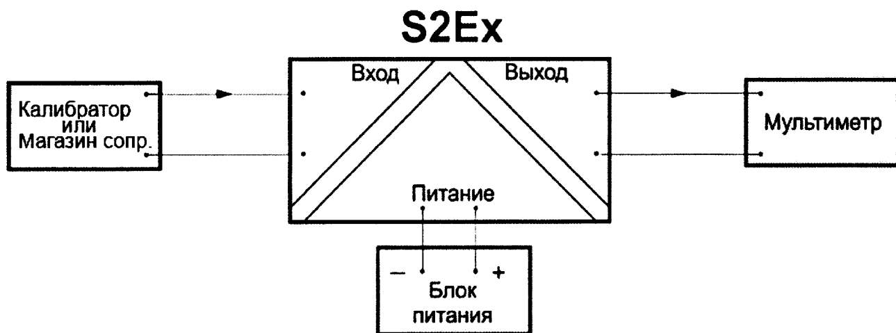
Рис. 2 – Схема подключения барьеров типа S2Ex
