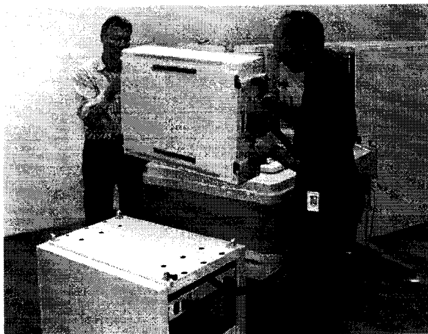
Рисунок 16 - Снятие устройства позиционирования с транспортной тележки
