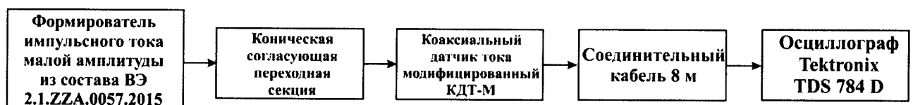
Рисунок 2 – Схема определения метрологических характеристики шунта коаксиального датчика тока модифицированного КДТ-М
