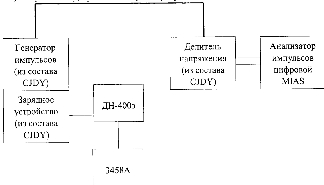
Рисунок 4 – Структурная схема проверки допускаемой относительной погрешности измерения и воспроизведения стандартизованных грозовых и коммутационных импульсов для напряжения свыше 500 кВ
