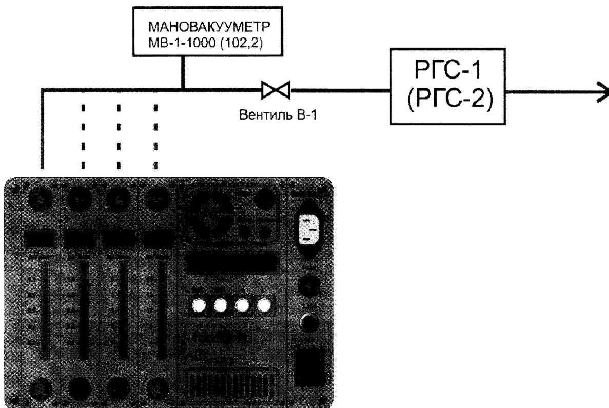
В-1 – вентиль для установки нагрузки не менее 250 мм.вод.ст.
