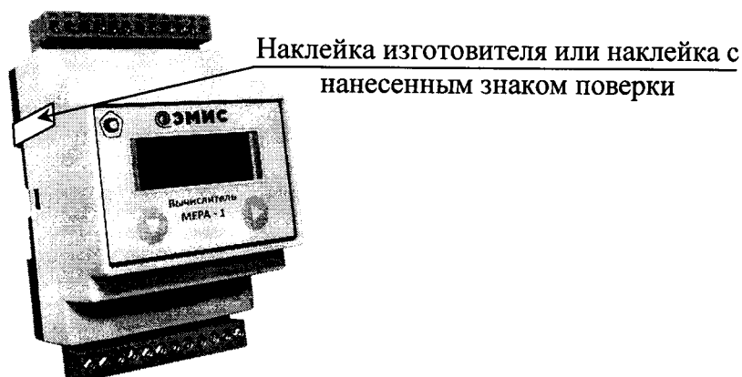
Рисунок 2 – Схема пломбировки вычислителя счетчиков раздельного исполнения
