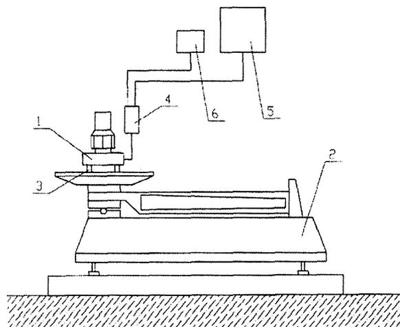
Рисунок 1. Принципиальная схема поверки измерителя угла наклона ИН-ДЗ(А)
