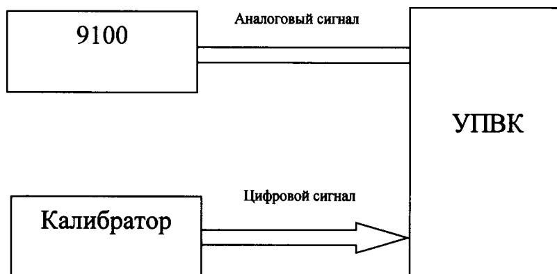
Рисунок 2 – Структурная схема проверки пределов допускаемых погрешностей воспроизведения частоты переменного тока калибраторов
