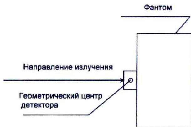
Рисунок 1 – Способ установки дозиметра с фантомом на поверочную дозиметрическую установку
