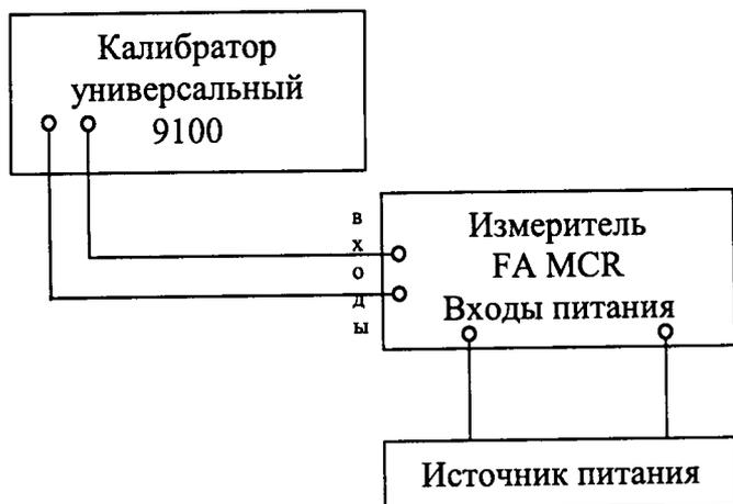
Рисунок 1 – Структурная схема проверки допускаемой приведенной (приведенной к максимальному значению диапазонов выходных сигналов) погрешности измерения
