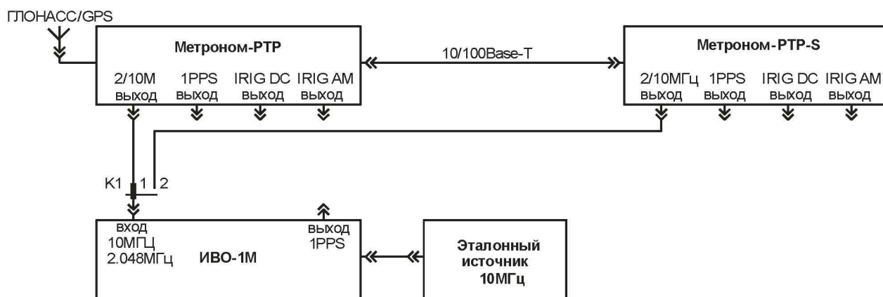
Рисунок 1 - Схема определение параметров низкочастотного шума МОВИ и ДВИ
