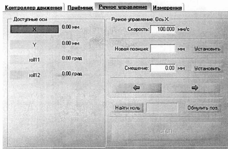
Рисунок 2 – Меню программы для ручного управления движением сканера
