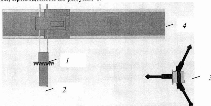
1 – антенна-зонд; 2 – оптический отражатель; 3 – система API OMNITRAC; 4 – сканер
