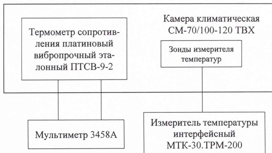
Рисунок 1 – Схема для проверки допустимой абсолютной погрешности измерения температуры окружающей среды
