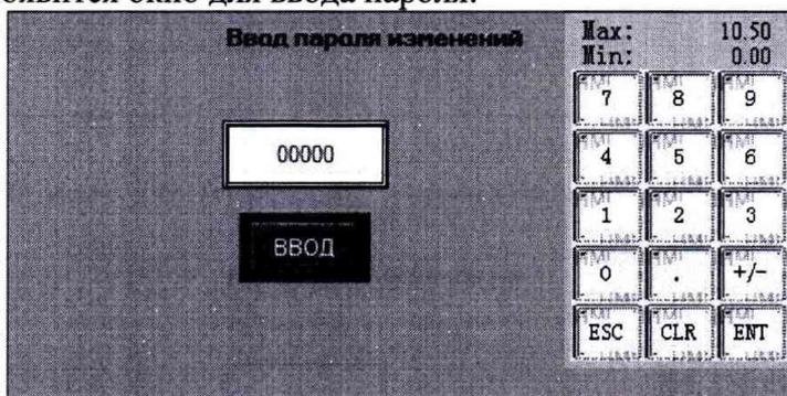
2.3.2.20 Ввести на сенсорной панели оператора (Альбом 2, рисунок 3) код пароля, после чего, нажать на клавишу ENT на панели оператора. Если введен правильный пароль, то на дисплее оператора появится окно:
