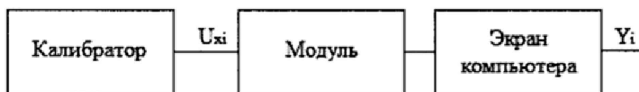
Рисунок 3 - Схема подключений при определении погрешностей ИК, реализующих аналого-цифровое преобразование сигналов от термомпар
