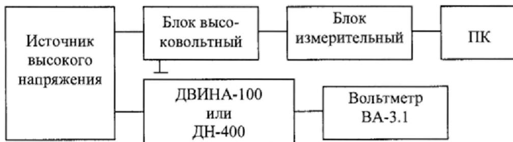
Рисунок 2 - Схема проверки на постоянном напряжении свыше 1000 В
