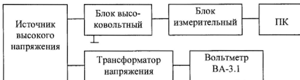
Рисунок 2 - Схема проверки на переменном напряжении свыше 1000 В
