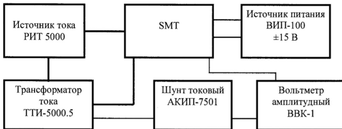
Рисунок 4 - Схема измерения силы тока свыше 200 А
