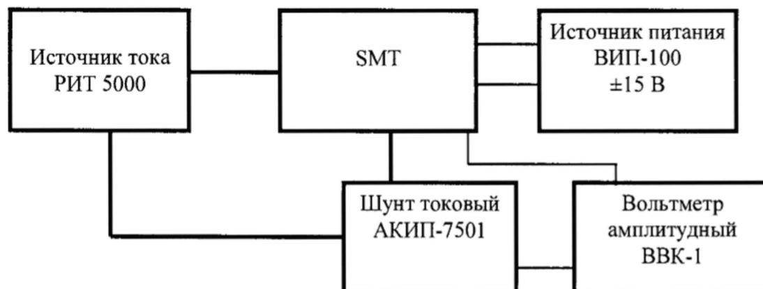
Рисунок 3 - Схема измерения силы тока от 5 до 200 А
