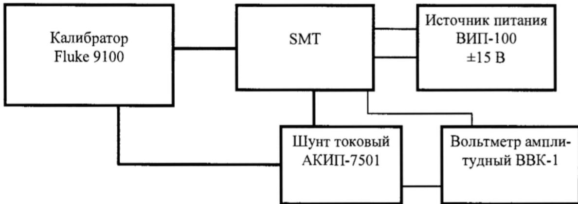
Рисунок 1 - Схема измерения силы тока до 5 А
