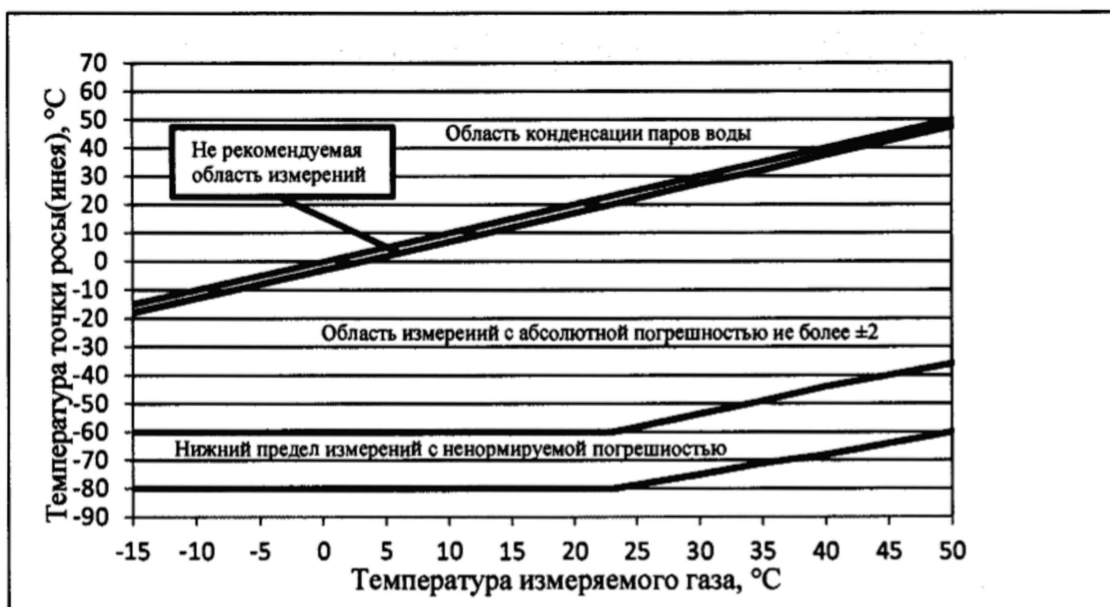
Рисунок 1 - Зависимость диапазона и абсолютной погрешности измерения температуры точки росы (иней) от температур измеряемого газа.
